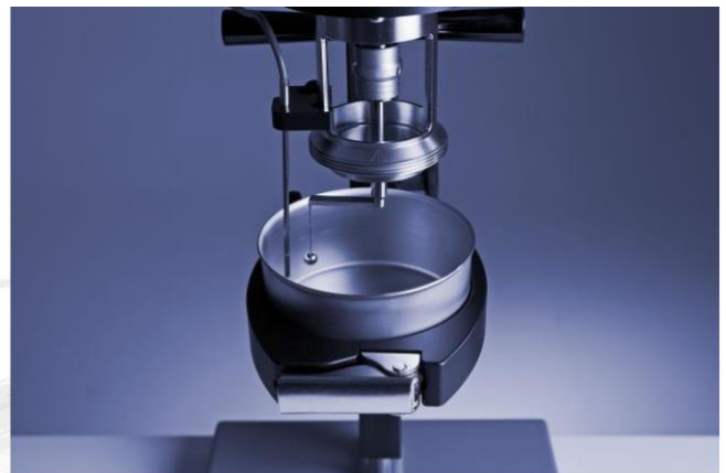
Рисунок 1: RheolabQC, оснащенный шаровой измерительной системой, состоящей из держателя чашки, мерной чашки и шаровой измерительной системы VM08/QC. Дополнительно внешний датчик температуры (Pt100) используется для измерения температуры в образце.
