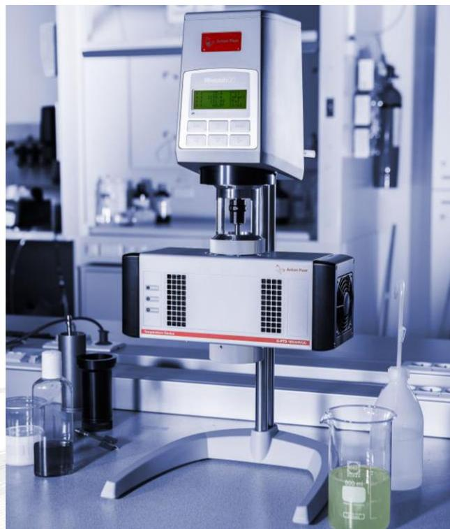
Рисунок 1: Реометр RheolabQC с C-PTD 180/AIR/QC
